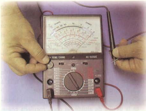
Figura 3.5. Calibración en cero del instrumento
